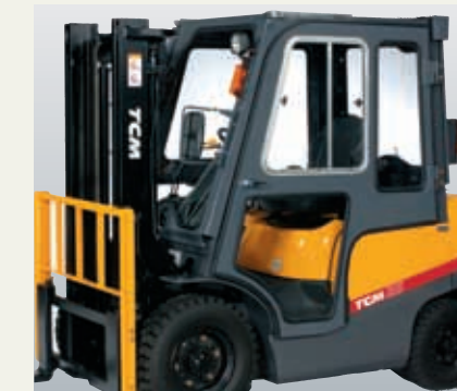
Кабина панельного типа (доступна для моделей грузоподъемностью 2 – 3,5 тонны)
