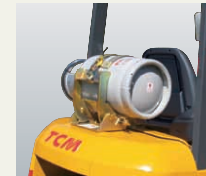
Баллон для высококачественного сжиженного газа/двойного топлива (сжиженного газа/бензина)
