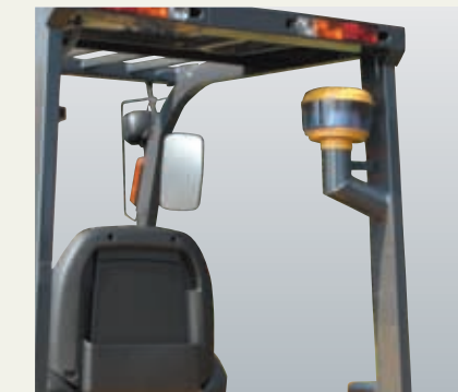
Воздухозаборник двигателя для предварительной очистки
