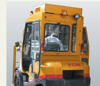
Стальная кабина закрытого типа с кондиционером (доступна для моделей грузоподъемностью 2 – 3,5 тонны)
